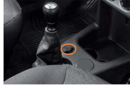
Situa-se no console central. Para utilizar a tomada de 12 V (potência máxima: 100 Watts), levante a proteção e conecte o acessório 12V.
