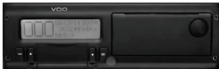
Se o seu veículo está equipado com um tacógrafo, localizado no painel central, permite cumprir as normas que regulamentam o trabalho do condutor. É responsabilidade do proprietário do veículo, no qual foi instalado o tacógrafo, controlá-lo e aferi-lo regularmente, segundo as leis vigentes.
