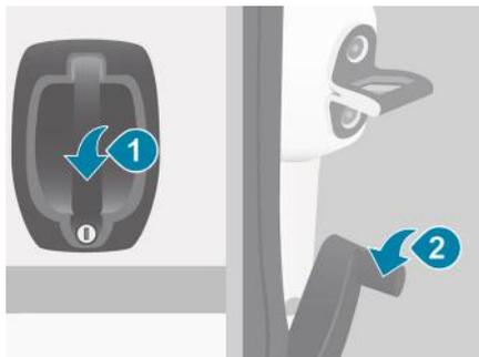
☞ Puxar a maçaneta na sua direção e puxar a alavanca para abrir a porta esquerda. Os dois batentes abrem-se a 96°.
