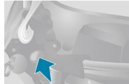
Para acessar o reservatório, desmontar a tampa de proteção localizada no lado esquerdo no cofre do motor, próximo da base do parabrisas. Rode um quarto de volta os seus três parafusos de fixação, depois retirar a segunda tampa em cima do tampão.
