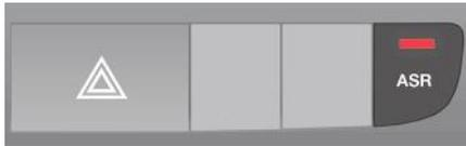
☞ Pressione este botão para desativar o sistema. O acendimento da luz de aviso do botão, acompanhada por uma mensagem na tela do painel de instrumentos, indica a desativação do sistema ASR.
