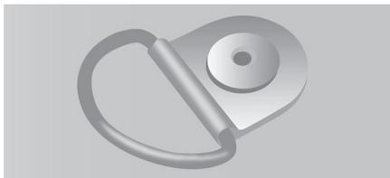
Dispõe de argolas de fixação no piso para fixar e acondicionar as cargas: 8, para os veículos de comprimento L2; 10, para os veículos de comprimento L3.
