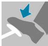
Pressione **com força** o pedal do acelerador e ultrapasse o **ponto de resistência** para ultrapassar o limite de velocidade programado.
