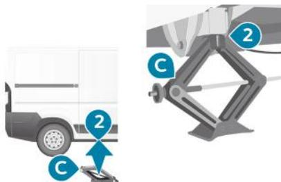
☞ Posicione o macaco **C** na posição **2**, no orifício existente sob o veículo.
