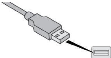
Insira a pen drive USB à tomada USB ou ligue o periférico USB à tomada USB através de um cabo adaptado (não fornecido).
