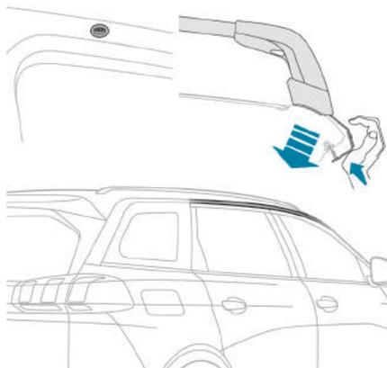
As barras transversais devem ser fixadas apenas nos quatro pontos de fixação localizados na armação do teto. Estes pontos são escondidos pelas portas do veículo quando estão fechadas.
