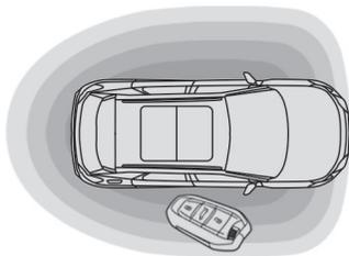
Sistema que permite o destravamento, o travamento e a partida do veículo com o porte da chave eletrônica.
