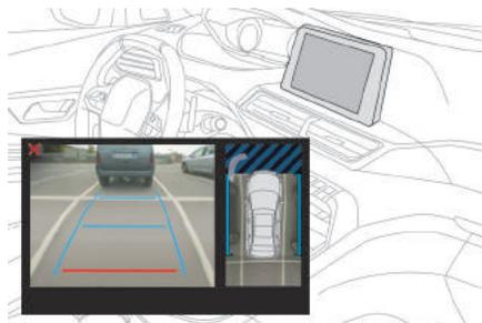
A tela divide-se em duas partes: à esquerda, uma visão de contexto; à direita, uma visão do topo do veículo.
