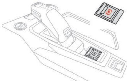
Este sistema permite, em funcionamento automático, o engrenamento do freio de estacionamento, quando o motor for desligado, e o desengrenamento, assim que o veículo for colocado em movimento.
