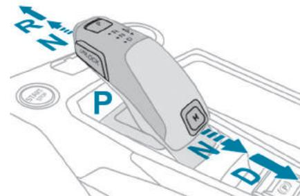
Pressione o seletor dando um ou dois impulsos para a frente (**N** ou **R**) ou para trás (**N** ou **D**), cruzando, se necessário, o ponto de resistência.
