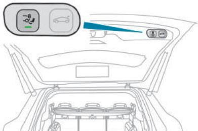
É possível ativar o travamento automático do veículo com o fechamento da tampa do porta-malas utilizando a função Acesso braços ocupados.
