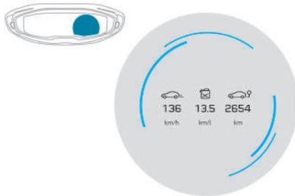
A exibição dos dados do computador de bordo é permanente se o modo de exibição "COMPUTADOR DE BORDO" ou "PESSOAL", de acordo com a versão, estiver ativo. Para todos os outros modos de exibição, pressionar a extremidade do comando do limpador de para-brisas apresentará estes dados temporariamente em uma janela específica.
