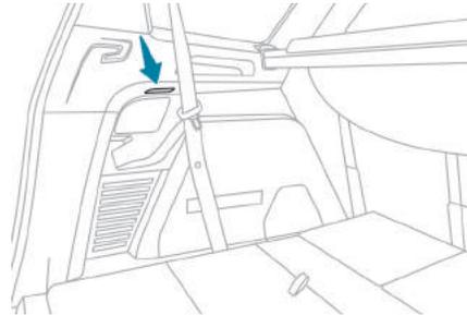
Acende-se automaticamente quando se abre o porta-malas e apaga quando se fecha a mesma.
