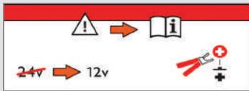
Na presença desta etiqueta, é fundamental utilizar apenas um carregador de 12 V, com o risco de provocar a degradação irreversível dos equipamentos elétricos associados.
