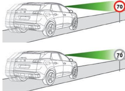
Por meio de uma câmara implantada na parte superior do para-brisas, este sistema detecta e lê os painéis de limitação de velocidade e de fim de limitação de velocidade.
