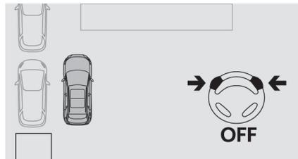
A manobra termina assim que o eixo das rodas dianteiras do veículo sair do espaço de estacionamento.
