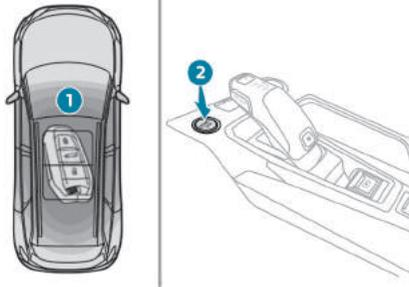
Com a chave eletrônica do Acesso e partida mãos livres no interior do veículo, a pressionar o botão "START/STOP", **sem nenhuma ação nos pedais**, permite ligar a ignição.
