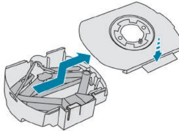
Esta caixa de ferramentas está instalada no centro da roda sobressalente, por baixo do veículo.
