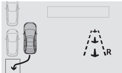
☞ Engrene a marcha à ré, largue o volante e dê a partida sem ultrapassar a velocidade de 7 km/h.
