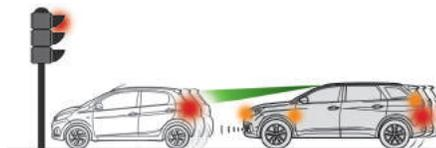
Esta função, também denominada frenagem automática de emergência, tem como objetivo reduzir a velocidade de impacto ou evitar a colisão frontal do seu veículo em caso de ausência de intervenção do motorista.
