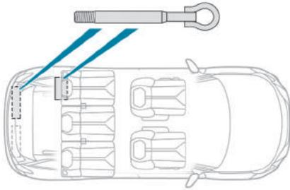
A argola de reboque encontra-se arrumada em uma caixa de ferramentas, sob a superfície inferior do porta-malas.
