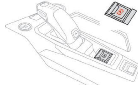
O desengrenamento completo do freio de estacionamento é confirmado pela extinção da luz indicadora de frenagem e da luz indicadora **P** do acionador, acompanhada pela apresentação da mensagem "Freio de estacionamento desengrenado".
