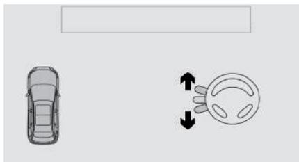
☞ Acione a seta, para o lado de estacionamento escolhido, para ativar a função de medição. Deverá deslocar-se a uma distância compreendida entre 0,5 m e 1,5 m da fila de veículos estacionados.
