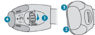
O **acionamento** do regulador de velocidade é manual: necessita de uma velocidade do veículo entre 30 km/h e 180 km/h. Com um câmbio automático, ela deverá estar em **D** ou **M**.
