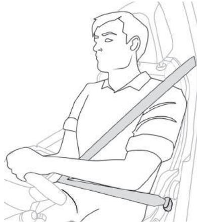
Coloque o cinto de segurança: coloque a cinta diagonal no centro do seu ombro e ajuste a cinta horizontal, deixando-a devidamente apertada na região do abdome.
