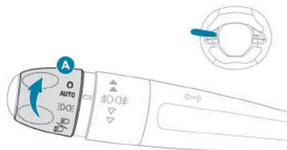
**O** Luzes apagadas (ignição desligada)/Luzes diurnas (motor em funcionamento).
