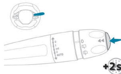
☞ Assim que o percurso pretendido for apresentado, pressione o botão localizado na extremidade do comando do limpador de para-brisas por mais de dois segundos.
