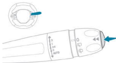
☞ Pressione o botão localizado na extremidade do **comando do limpador de para-brisas**, para visualizar os diferentes modos em sequência.
