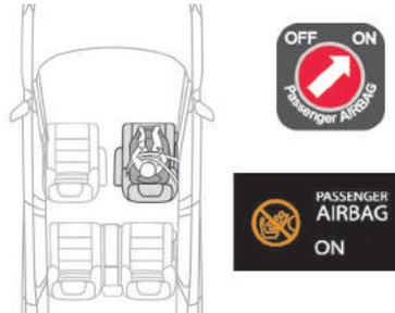
Quando uma cadeira para crianças "voltada para a frente" for instalada no **assento do passageiro dianteiro**, regule o banco do veículo para a posição longitudinal traseira máxima, posição mais alta, com as costas do banco eretas. Deixe o airbag do passageiro ativo.
