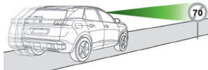
Por meio de uma câmara implantada na parte superior do para-brisas, este sistema detecta e lê os painéis de limitação de velocidade e de fim de limitação de velocidade.
