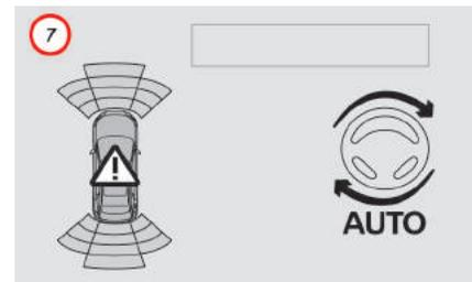
☞ A manobra de estacionamento assistida está em curso. Sem ultrapassar a velocidade de 7 km/h, efetue as manobras de avanço e de recuo, com base nos avisos da função "Auxílio ao estacionamento", até a indicação de fim da manobra.
