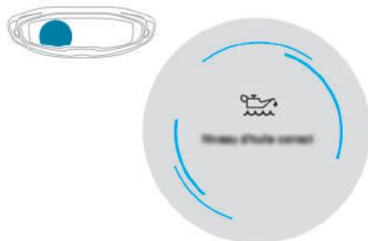
Nas versões equipadas com medidor elétrico, a conformidade do nível de óleo do motor é apresentada durante alguns segundos no painel, ao ligar a ignição, após a informação de manutenção.
