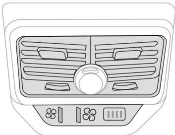
Quando esta função for ativada, o ventilador traseiro funciona. Neste caso, os passageiros traseiros podem controlar o fluxo de ar destes ventiladores independentemente do controle do fluxo de ar do ar condicionado para os ventiladores dianteiros.
