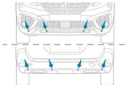
Com a ajuda dos sensores localizados no para-choques, esta função indica a proximidade de obstáculos (exemplos: trabalhadores na pista, veículos, árvores, barreiras...) que entrem no respectivo campo de detecção.
