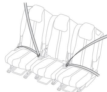
Cada um dos bancos traseiros da 2.<sup>a</sup> fila vem equipado com um cinto, com três pontos de fixação e um enrolador.
