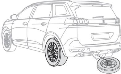
A roda sobressalente é fixada por um sistema de guincho por baixo da traseira do veículo.
