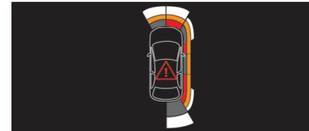
Com quatro sensores adicionais situados ao lado dos para-choques, o sistema regista a posição dos obstáculos durante a manobra e assinala-os quando estes se encontram ao lado do veículo.
