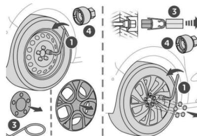
▶ Com rodas de aço, remova a calota de roda com a ferramenta **3** ou remova a calota das rodas com à mão.
