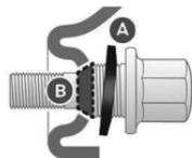
Se o veículo estiver equipado com rodas de alumínio, as anilhas **A** não devem entrar em contato com a roda sobressalente de aço ou utilização temporária. A roda é mantida no respectivo local pela superfície de contato cônica **B** de cada parafuso.
