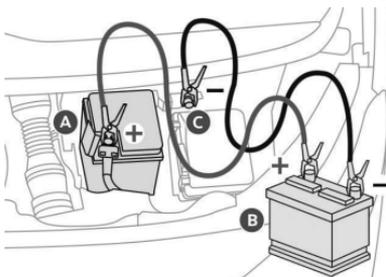
▶ Levante a proteção de plástico no terminal (+), se o veículo estiver equipado com uma.
