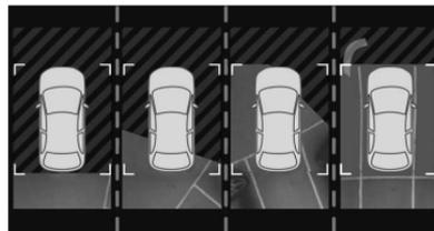
Com a ajuda da câmara traseira, o ambiente em redor do veículo é registado durante a realização de manobras a baixa velocidade. É reconstruída uma imagem de cima do veículo na sua zona circundante (representada entre parêntesis) em tempo real e à medida que a manobra progride. Isto facilita o alinhamento do veículo durante o estacionamento e apresenta os obstáculos nas proximidades. Apaga-se automaticamente se o veículo ficar demasiado tempo parado.
