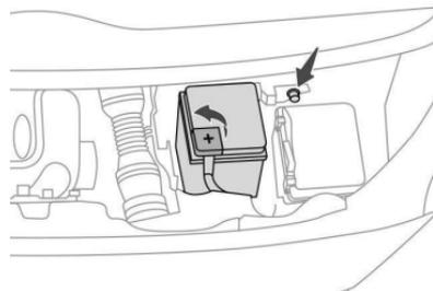
► Retire a proteção de plástico para acessar ao terminal (+) se o seu veículo estiver equipado.
