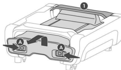
► Pressione os trincos **A** e deslize-os para dentro para soltar a caixa.
