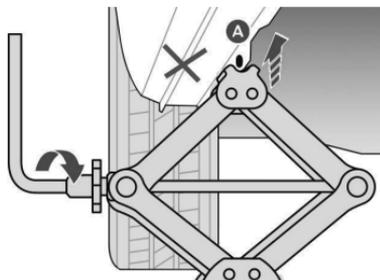
► Use o botão para subir o macaco **2** até que a cabeça entre em contato com a posição **A** ou **B** utilizada; a superfície de contato **A** ou **B** do veículo deve ficar bem engatada na parte central da cabeça do macaco.
