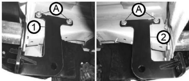
Os suportes de fixação do engate (1 e 2) devem ser fixados nos pontos de fixação A indicados para a fixação nas longarinas traseiras.
