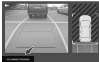
Para ativar a câmara situada na tampa do porta-malas, engrene a marcha a ré e não exceda uma velocidade de 10 km/h. O sistema está desativado:
