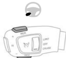
Com este botão pode seleccionar uma velocidade de referência memorizada para utilizar com o limitador de velocidade ou o regulador de velocidade programável.
