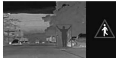
O alcance de deteção da câmara situa-se entre 15 m (para pedestres) e 200 m, dependendo das condições de visibilidade.
