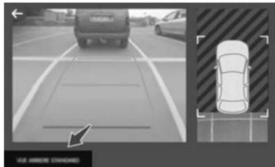
O sistema ativa-se automaticamente ao engrenar a marcha a ré.
