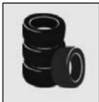
**Pneus** - Confira a cada 15 dias a calibragem dos pneus e utilize a pressão indicada para seu veículo no manual de instruções.
