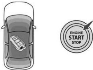
Com a chave eletrônica no habitáculo, pressionando o botão **"START/STOP"**, **sem pisar em qualquer pedal**, permite ligar a ignição sem ligar o motor (o painel
