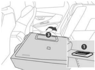
► Coloque o encosto **3** para cima e empurre-o com força para fixar o sistema de travamento.
