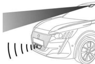
O veículo possui uma câmera multifuncional situada na parte superior do para-brisas e, de acordo com a versão, um radar situado no para-choque dianteiro.
