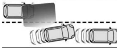
Enquanto os indicadores de mudança de direção estiverem ativados e alguns segundos após a sua desativação, o sistema considera que qualquer desvio de trajetória é intencional e não aciona qualquer correção durante este período. No entanto, com o sistema de alerta de pontos cegos ativado, se o condutor começar a mudar de via e outro veículo for detectado no ponto cego do veículo, o sistema corrige a trajetória mesmo que os indicadores de mudança de direção estejam acesos.
