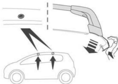
Deve-se fixar as barras transversais apenas nos quatro pontos de fixação situados na estrutura do teto. Estes pontos estão tapados pelas portas do veículo quando estas estão fechadas. As fixações das barras do teto têm um pino que deve ser inserido na abertura de cada ponto de fixação.
