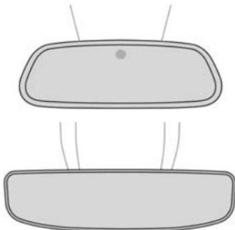
Este sistema alterna, de maneira automática e progressiva, entre os modos de dia e noite, através de um sensor que mede a entrada de luz na parte de trás do veículo.
