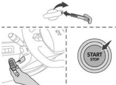
► Insira a chave mecânica (integrada no telecomando) na fechadura para abrir o veículo.
