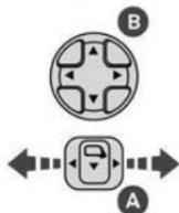
► Desloque o comando **A** para a direita ou para a esquerda para selecionar o retrovisor correspondente.
