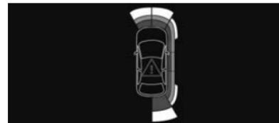
Com quatro sensores adicionais situados ao lado dos para-choques, o sistema regista a posição dos obstáculos durante a manobra e assinala-os quando estes se encontram ao lado do veículo.
