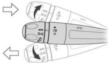
► Esquerda ou direita: desloque o comando de iluminação para baixo
