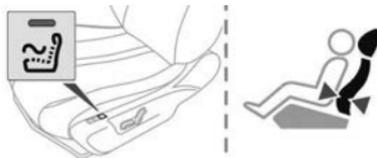
Esta função assegura uma massagem lombar e só funciona com o motor em funcionamento e no modo STOP do sistema Stop & Start.
