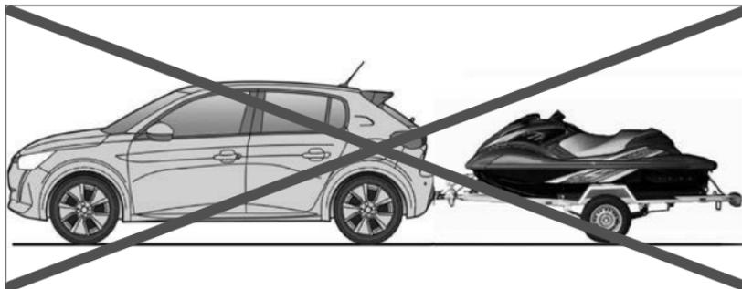
**!** Seu veículo foi projetado para o transporte de pessoas e de bagagens. Está vedada a instalação de gancho de reboque, sob pena de deteriorização do veículo. Em caso de dúvidas, entre em contato com uma concessionária da Rede PEUGEOT.
