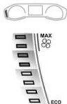
O indicador mostra o consumo de energia elétrica das funções de conforto térmico.
