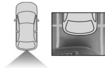
A câmara regista a área à volta do veículo durante a manobra para reconstituir uma imagem a partir da parte traseira do veículo no ambiente em que se encontra, permitindo realizar a manobra do veículo contornando obstáculos circundantes.
