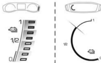
O estado de carga da bateria de tração e a autonomia restante são apresentados de maneira contínua quando o veículo é ligado.
