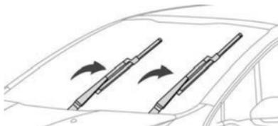
▶ No espaço de um minuto após desligar a ignição, qualquer operação do comando do limpa-vidros posiciona as palhetas do limpa-vidros dianteiro na vertical.
