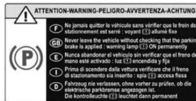
! Antes de sair do veículo, verifique se o freio de estacionamento se encontra engrenado: as luzes indicadoras no painel de instrumentos e no comando devem estar acesas de forma fixa.
