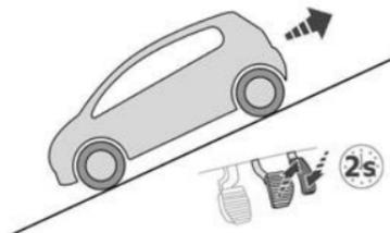
**Em descidas, com o veículo imobilizado e marcha a ré engrenada, este é mantido durante um curto período de tempo quando libera o pedal do freio.**
