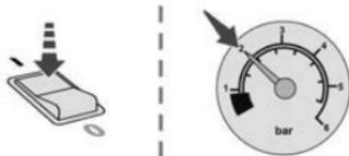
► Ligue o compressor, colocando o interruptor na posição "I" até a pressão dos pneus atingir 2 bar. O produto de selagem é injetado, sob pressão, no pneu. Não retire o tubo da válvula durante este processo (risco de respingos).
