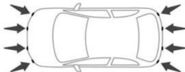
Servindo-se de sensores localizados nos para-choques, esta função indica acerca de proximidade de obstáculos (por exemplo, pedestres, veículos, árvores, barreiras) que entram no seu campo de detecção.
