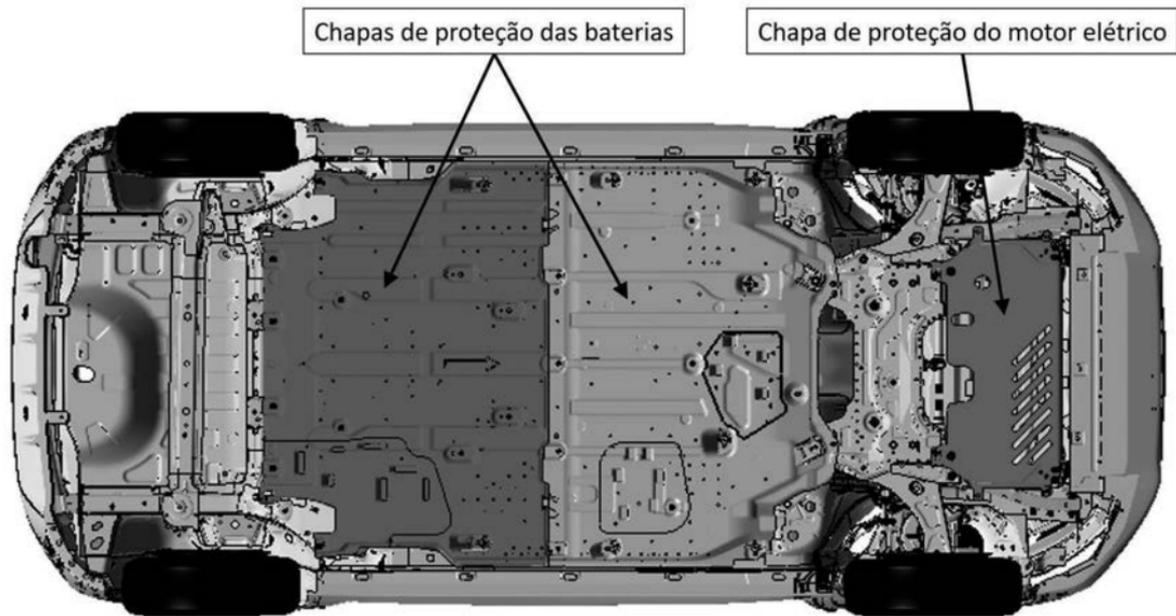
Chapas metálicas protetoras inferiores do veículo para a proteção do motor e das baterias devido à altura livre do solo do veículo.
