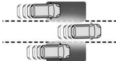
Este sistema inclui sensores, instalados na parte lateral dos para-choques e indica o condutor sobre a presença potencialmente perigosa de outro veículo (automóvel, caminhão, motocicleta) nas áreas de ponto cego do veículo (áreas fora do campo de visão do condutor).
