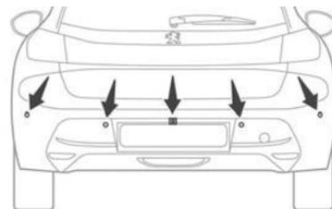
Com o motor funcionando e assim que a marcha a ré é engrenada, este sistema permite visualizar imagens das zonas à volta do seu veículo na tela táctil utilizando uma câmara localizada na traseira do veículo.
