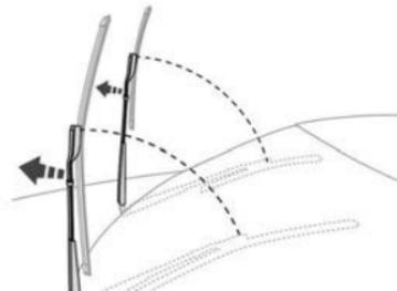
▶ Substitua estas palhetas do limpa-vidros dianteiro pelo lado do condutor.
