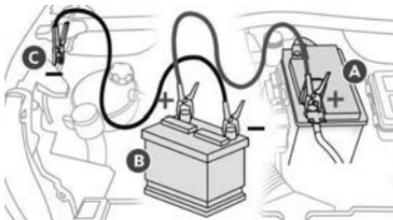
▶ Levante a proteção de plástico no terminal (+), se o veículo estiver equipado com uma.
