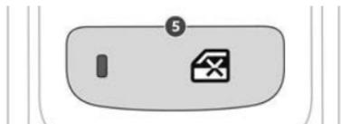
Para a segurança do seu filho, pressione o controle **5** para desativar os comandos dos vidros elétricos traseiros, independentemente das posições.
