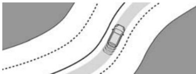
Através de uma câmara existente na parte superior do para-brisas, o sistema identifica as marcações na via de circulação e mantém o veículo dentro da faixa escolhida pelo condutor.
