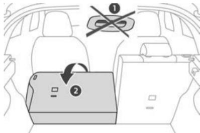
► Coloque o encosto **2** para cima e empurre-o com força para fixar o sistema de travamento.
