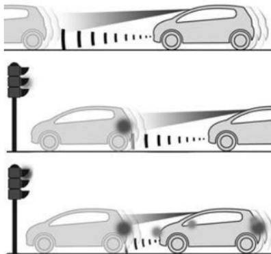
Esta função, também designada por frenagem automática de emergência intervem após alertas se o condutor não reagir de forma suficientemente rápida e não acionar os freios do veículo.
