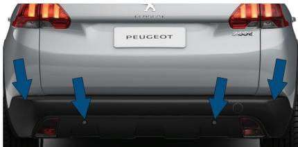
A colocação em funcionamento é obtida através do engrenamento da marcha a ré, sendo acompanhada de um sinal sonoro.
