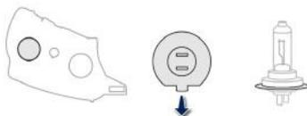
Para proceder a montagem, efetue estas operações pela ordem inversa, colocando o entalhe de posicionamento da lâmpada para baixo.
