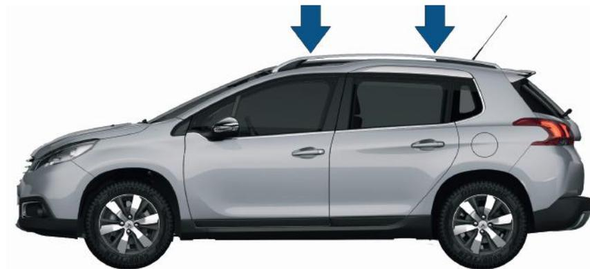
**i** Peso máximo autorizado no porta-bagagens de teto, para uma altura de carregamento que não ultrapasse os 40 cm (exceto para o suporte de bicicletas): **65 kg**.
