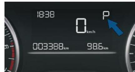
Quando deslocar a alavanca na grelha para selecionar uma posição, acende o respectivo indicador no visor do painel de instrumentos.
