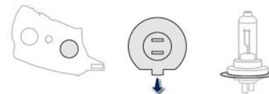
Para a montagem, efetue estas operações pela ordem inversa, colocando o entalhe de posicionamento da lâmpada para baixo.
