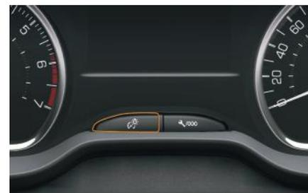
Com as luzes acesas, pressionar o botão **esquerdo** para aumentar a intensidade da iluminação do posto de condução e do ambiente do veículo. Para reduzir a intensidade da iluminação, aperte o botão até atingir a luminosidade máxima e depois pressione novamente para reduzir.
