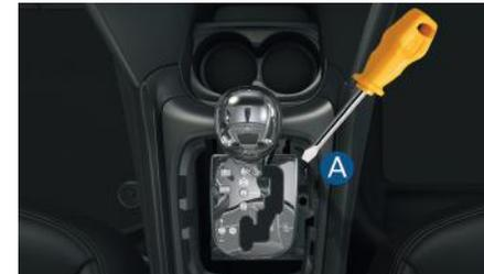
Destravar o "shift lock" pressionando em "A" com uma chave de fendas. Manobrar a alavanca de seleção de velocidades para deixar a posição "P". Instalar com cuidado o acabamento (1).
