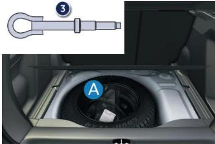
O gancho de reboque **3** encontra-se instalado no porta-malas, dentro da bolsa de ferramentas **A**, sob o tapete.
