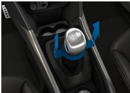
☞ Levante o anel sob o comando e desloque a alavanca de marchas para a esquerda e depois para a frente.
