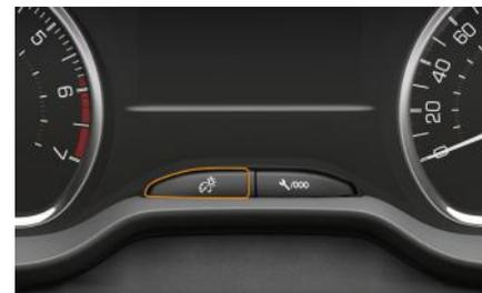
Com as luzes acesas, pressionar o botão **esquerdo** para aumentar a intensidade da iluminação do posto de condução e do ambiente do veículo. Para reduzir a intensidade da iluminação, aperte o botão até atingir a luminosidade máxima e depois pressione novamente para reduzir.
