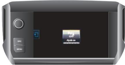
Para ativar ou desativar a função ou ajuda ao estacionamento, ingresse ao menu da tela táctil, em seguida ir para tela ajustes do veículo e ative ou desative a função de ajuda ao estacionamento.
