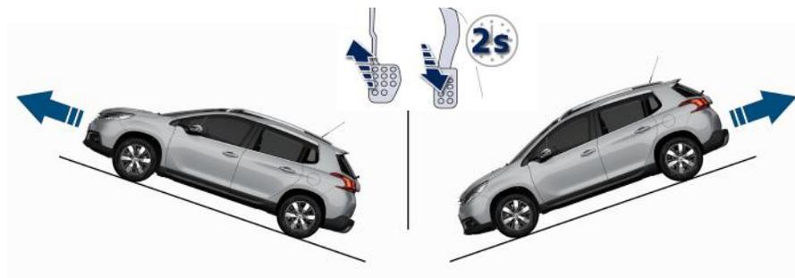
**Em subidas, com o veículo imobilizado, este é mantido durante um curto instante, durante a liberação do pedal de freio:**
