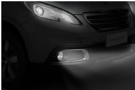
Com os faróis baixos ou altos ligados, esta função permite que o feixe de luz do farol de neblina ilumine o interior da curva, quando a velocidade do veículo for inferior a 40 km/h (condução urbana, estrada perigosa, cruzamentos, manobras de estacionamento...).
