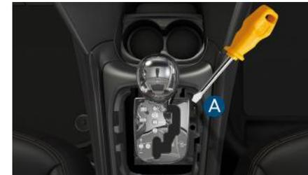
Destravar o "shift lock" pressionando em "A" com uma chave de fendas.
