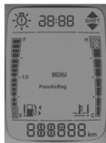
Essa função permite ativar ou desativar o airbag frontal do lado do passageiro através dos botões ▲ e ▼ no conjunto de botões situado na parte superior do painel.
