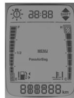
Essa função permite ativar ou desativar o airbag frontal do lado do passageiro através dos botões ▲ e
