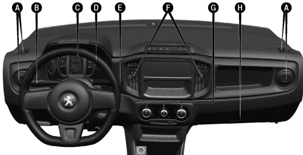
A. Difusores de ar laterais – B. Alavanca esquerda (comando de farol alto/baixo e luzes de direção) – C. Quadro de instrumentos – D. Volante – E. Alavanca direita (comando de limpeza/lavagem dos vidros) – F. Difusores de ar centrais – G. Comandos de aquecimento, ventilação e ar-condicionado – H. Porta-luvas
