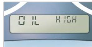
Se a mensagem **“OIL HIGH”** for exibida, isso significa que o nível de óleo é excessivo e, dessa forma, é necessário reduzir o volume de óleo no cárter.
