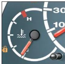
**Indicador de temperatura do líquido de arrefecimento****Luz indicadora de alerta de temperatura do líquido de arrefecimento**
