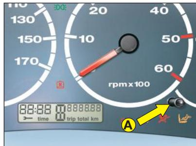
Uma pressão do botão **A** permite alternar a exibição do hodômetro total com o parcial.
