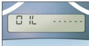
**Uma piscada das barras indica um incidente de funcionamento do indicador ou falta de óleo.**
