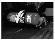
A validade do extintor de incêndio está vinculada ao teste hidroestático (teste para verificação de vazamentos do cilindro), que deve ser feito a cada 5 anos, a partir da data de fabricação gravada no corpo do cilindro.
