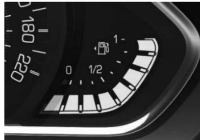
Mostra o nível de combustível no reservatório quando se coloca a chave de ignição na posição 2.
