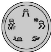
Em condições excepcionais (saída do veículo atolado, imobilizado na neve, em solo instável, etc.), poderá ser aconselhável desativar o sistema ASR para permitir que as rodas girem livremente e recuperem a aderência.
