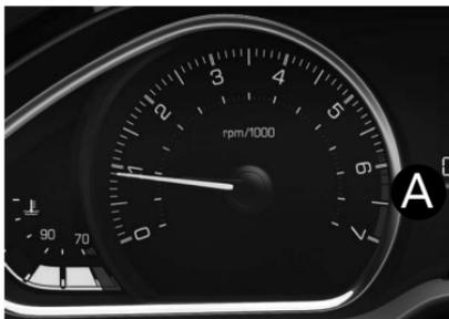
! Ao aproximar-se do limite máximo de rotações **A**, o sistema de injeção eletrônica corta o fluxo de combustível para proteção do motor. Este corte de combustível ocasiona perda de potência do motor.
