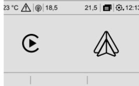
Execute determinadas aplicações do smartphone conectado através de CarPlay® ou Android Auto®. O smartphone deve estar conectado via cabo na tomada USB. Verifique a compatibilidade com o seu smartphone. Acesso ao computador de bordo.
