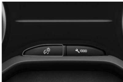
Sistema para adaptar manualmente a intensidade luminosa do visor do painel de instrumentos em função da luminosidade exterior.
