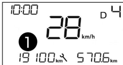
O indicador de manutenção **1** é apresentado durante alguns segundos ao ligar a ignição. Informa o motorista sobre o prazo para a próxima revisão a efetuar, de acordo com o plano de manutenção do construtor.
