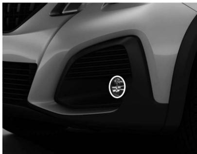
Com os faróis baixos ou altos ligados, esta função permite que o feixe do farol de neblina ilumine o interior da curva, quando a velocidade do veículo for inferior a 40 km/h (condução urbana, estrada perigosa, interseções, manobras de estacionamento...).
